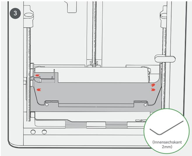
Entfernen Sie die vier Schrauben, wie die Pfeile zeigen.
