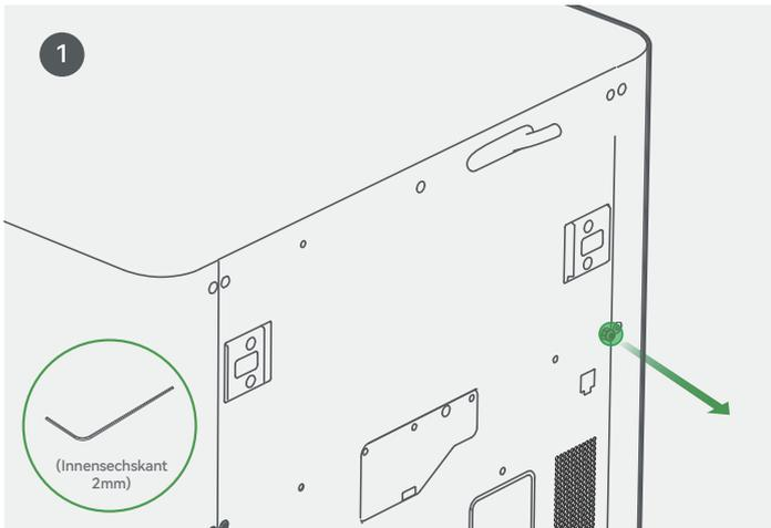
Entfernen Sie die Schraube wie abgebildet mit einem Innensechskantschlüssel 2mm.
