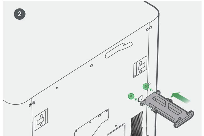
Befestigen Sie den Spulenhalter mit zwei Schrauben aus der Zubehörbox.
