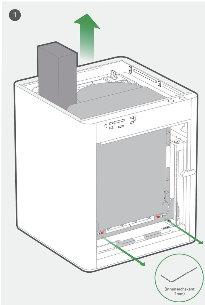
Nehmen Sie die Zubehörbox heraus. Entfernen Sie die Schrauben wie abgebildet mit dem Innensechskantschlüssel 2mm.
