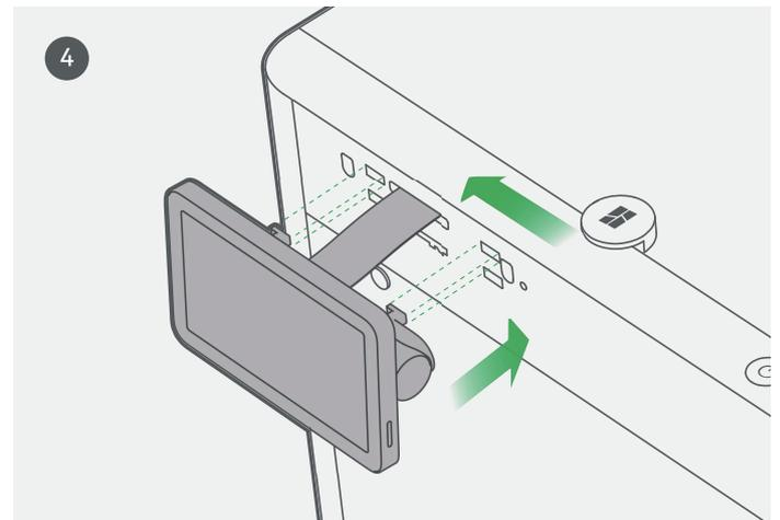
Setzen Sie den Bildschirm wieder in den Steckplatz am Drucker ein und verriegeln Sie ihn, indem Sie ihn nach links drücken.
