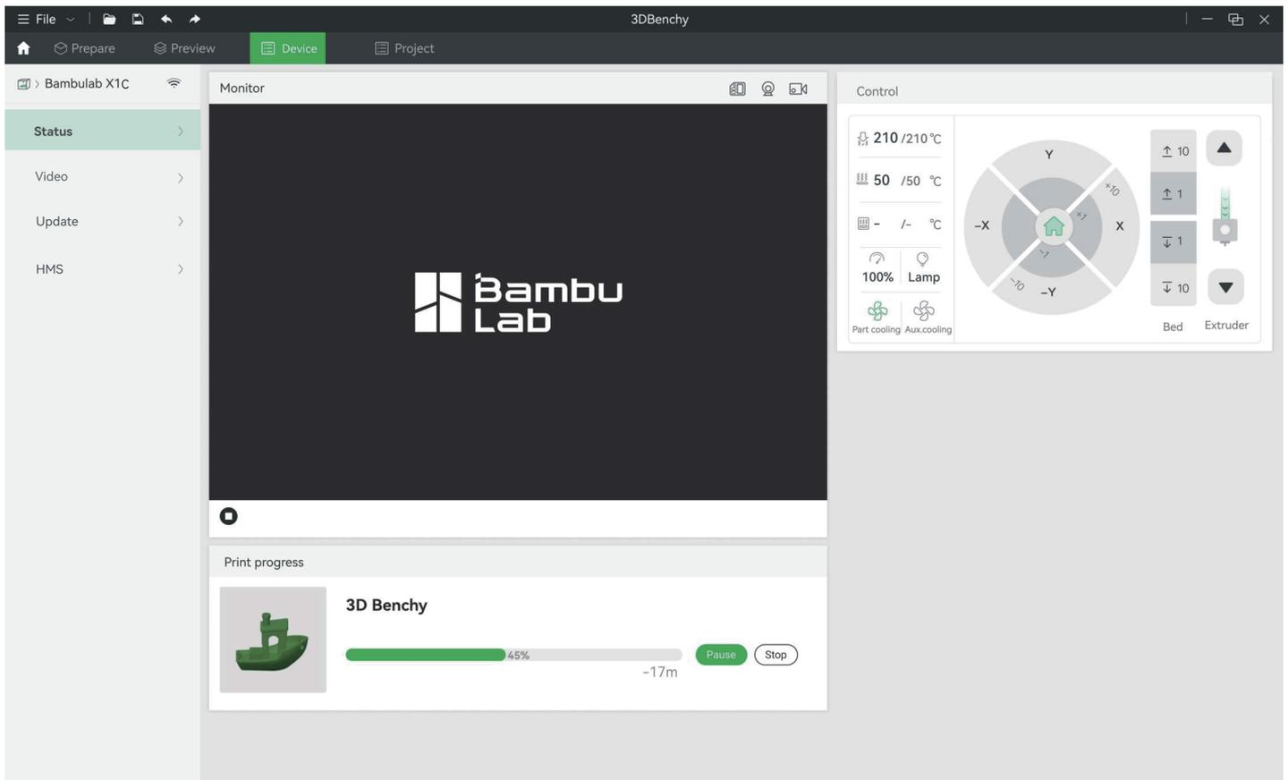
Während des Drucks können Sie Ihren Auftrag aus der Ferne überwachen oder den Druck über die Schnittstelle "Gerät" anhalten/stoppen.
